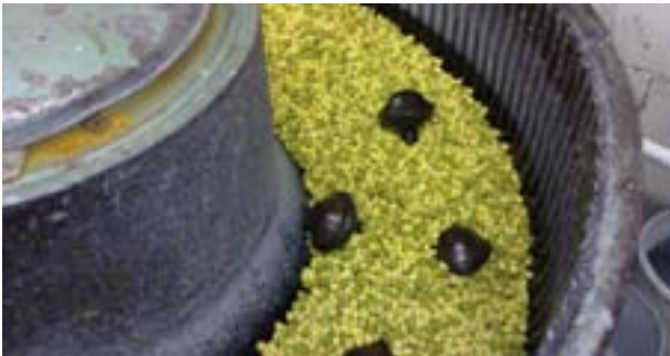
Rumble polishing composite door knobs
